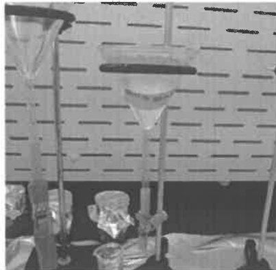
Figura 1: Sistema de separación por densidades
